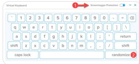
Figura 4.9 – Protezione contro screenlogger / funzione di layout casuale tastiera
